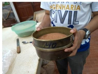
**Imagem 7:** Ensaio de granulometria por peneiramento.
