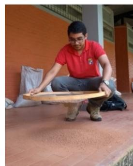
**Imagem 4:** Processo de destorroamento por peneiramento. colocada em estufa, conforme apresentado na Imagem 5, para determinação de umidade natural, em laboratório.
