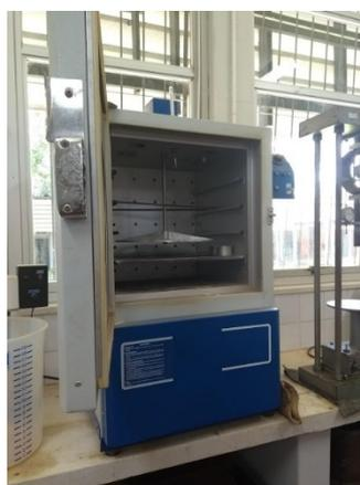
**Imagem 52:** Solo em amostra em estufa para determinação da umidade natural.
