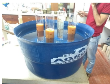
Imagem 10: Ensaio de sedimentação.
