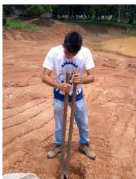
Imagem 2: Escavação para coleta do solo.
