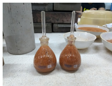
Imagem 9: Ensaio de densidade
